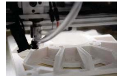
Deux têtes d'extrusion indépendantes mécaniquement → L'impression bi-matériaux sans échec
