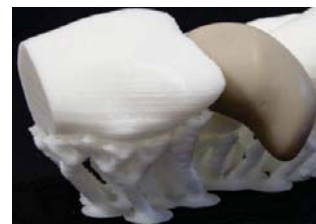
Modèle médical Apium M220 imprimant du PEEK sans affecter sa biocompatibilité et ses propriétés de stérilisation
