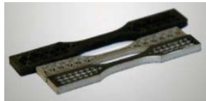
Inox 316L avant et après post-traitement « Type MIM »
